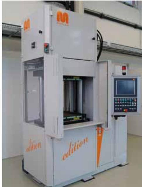
Leihgabe der Firma Maplan, um Experimente zur Heizzeitverkürzung im Rahmen des BRIDGE-Projekts durchzuführen.
